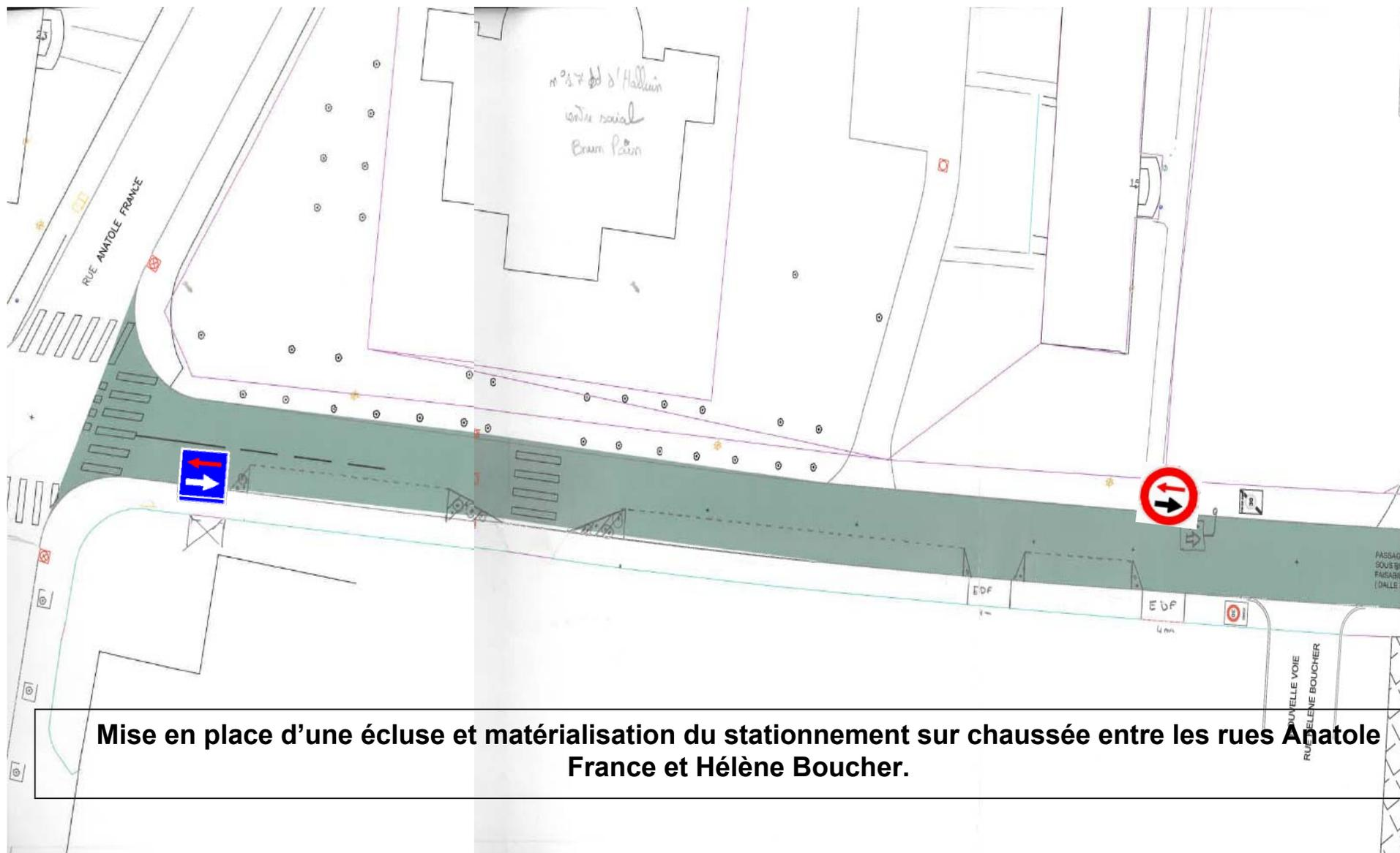
Mise en place d'une écluse et matérialisation du stationnement sur chaussée entre les rues Anatole France et Hélène Boucher.
