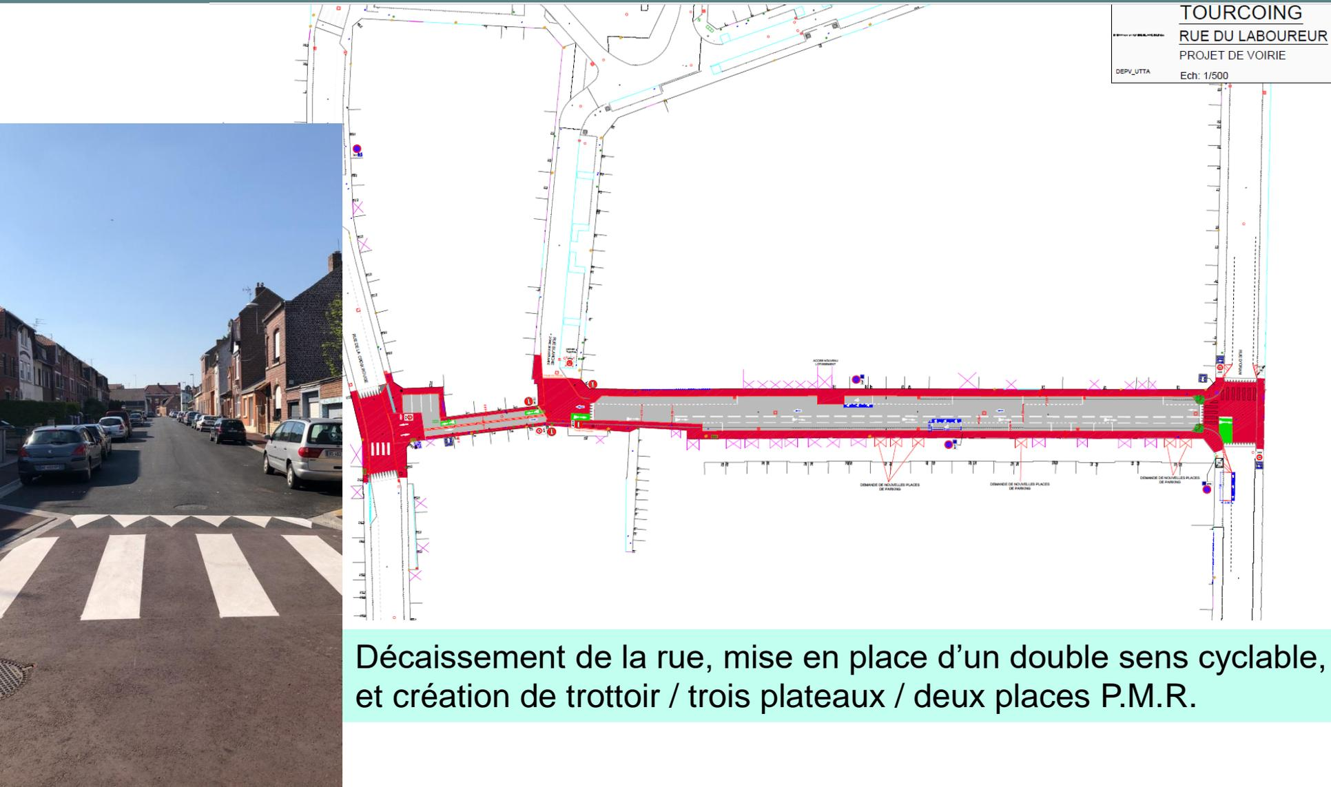
Décaissement de la rue, mise en place d'un double sens cyclable, et création de trottoir / trois plateaux / deux places P.M.R.
